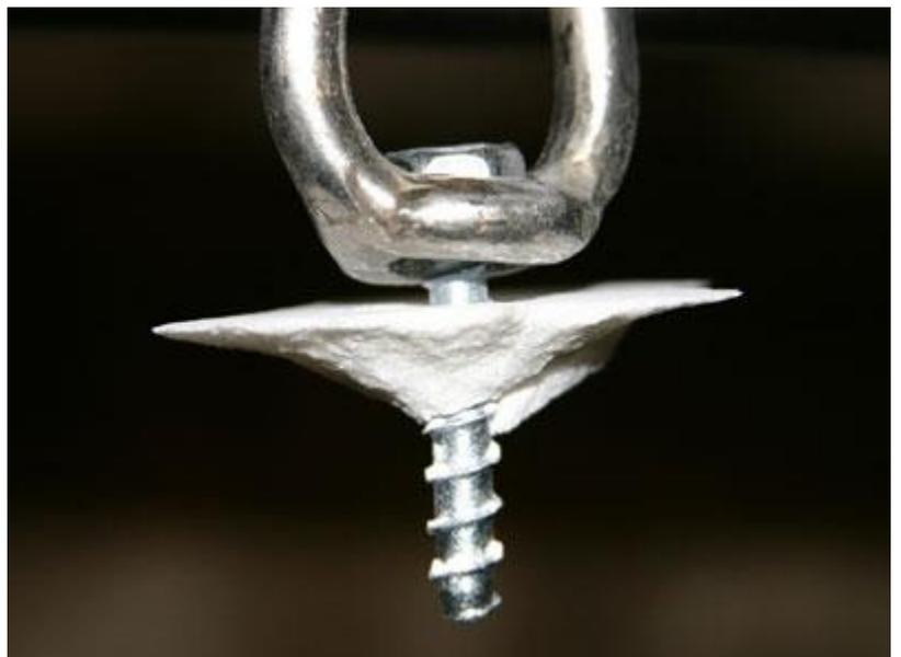
"avvitato", quindi recuperato e riutilizzato (non nel granito), permettendo fra l'altro di ridurre l'"inquinamento" delle grotte e delle montagne, molte delle quali letteralmente crivellate da spit, fix e "chimici";
