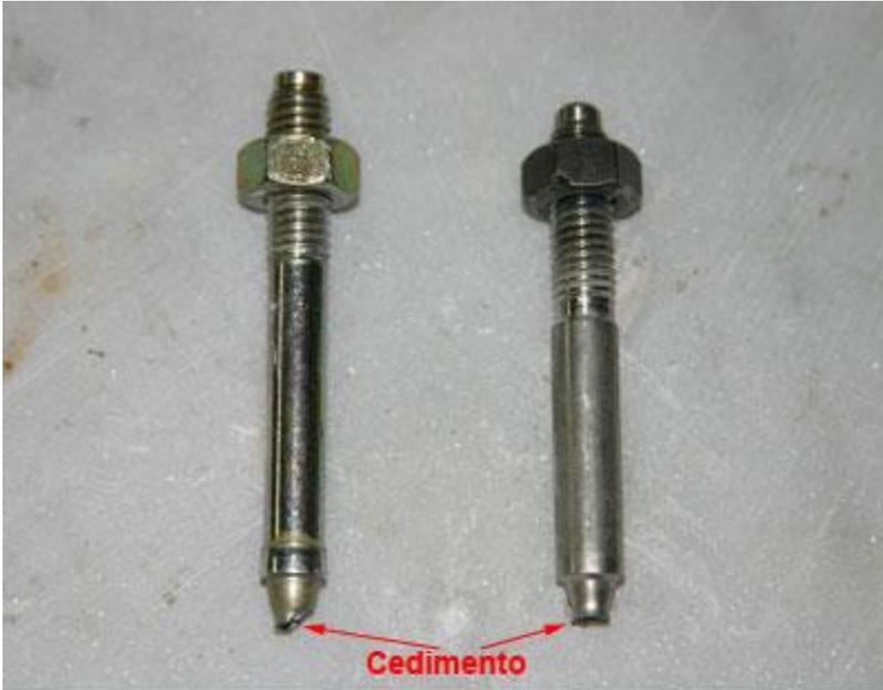
Nei Fix il problema è particolarmente presente anche per la struttura stessa del gambo immerso nel foro, dove, a livello delle parti mobili che espandendosi creano la pressione, c'è una sezione trasversale particolarmente ridotta che è spesso causa del cedimento del tassello (vedi immagine a lato).
