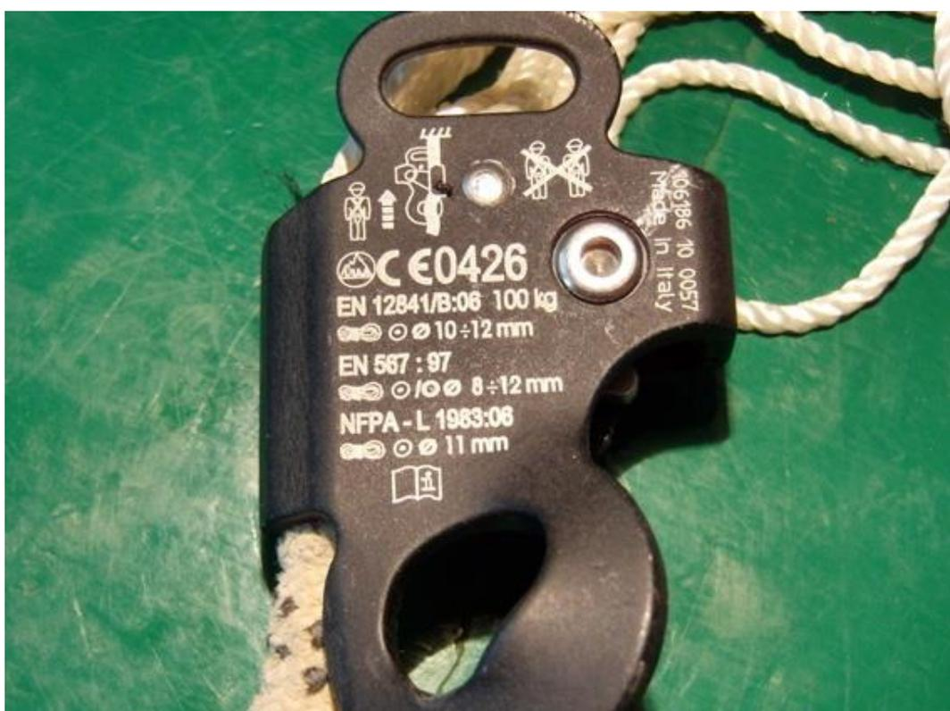
La situazione è pressoché identica la Croll 2013, anche se nel Body è presente l'antiribaltamento: l'allargamento della gola è conseguenza di una certa debolezza della struttura in lega ma anche dall'impossibilità del cricchetto, con una corda da 10 mm di diametro, di raggiungere il fine corsa. Si ha una violenta strozzatura della corda nella gola perché l'antiribaltamento è spostato troppo a destra (relativamente alla quarta foto).
