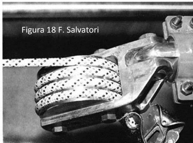
L'aggancio delle corde (e dei cordini) ai bracci di trazione del dinamometro col **sistema-tamburi** permette che non si verifichino contatti che possano portare a indebolire o a rompere i fili elementari della corda (lacerazioni, incisioni e deformazioni meccaniche; riscaldamento per attrito).
