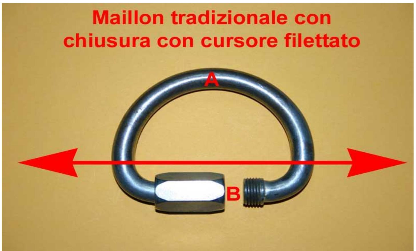
E' questo un ulteriore caso di fragilità di un possibile elemento della catena di sicurezza, tanto più potenzialmente pericoloso se lo confrontiamo con i valori di forza ottenuti durante una normale progressione.
