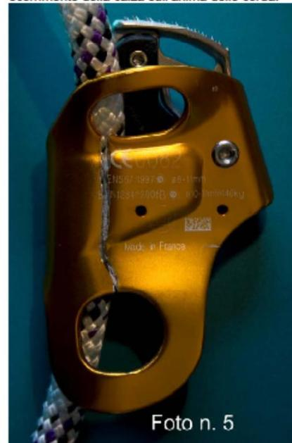
Nei test a caduta ( $v_d = 4,429 \text{ s}^{-1}$ ) la gola non si è aperta e il cricchetto non si è ribaltato, ma dopo la rottura della calza tutti i trefoli sono stati tranciati a rapida successione. In questi casi il bloccante è risultato inutilizzabile in quanto la gola si è aperta di alcuni millimetri e la corda poteva fuoriuscire con una minima trazione trasversale.
