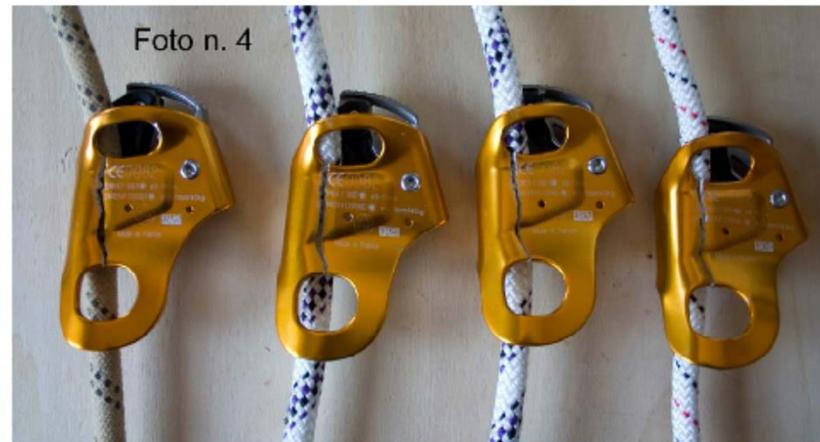
In alcuni casi la gola non si è aperta completamente, il cricchetto sia pur di poco non si è ribaltato, la calza si è rotta, ma immediatamente dopo il cricchetto a strozzato a tal punto i trefoli da romperli tutti in pochissimo tempo. Non si è innescato alcun fenomeno di dissipazione di energia con scorrimento della calza sull'anima delle corde.
