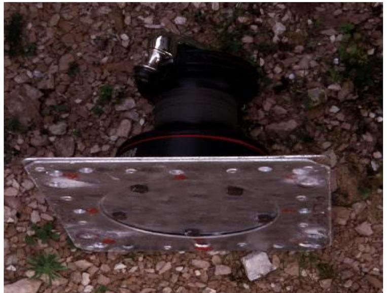
struttura, trazionata al dinamometro (vedi foto a destra), ha sopportato sollecitazioni fino a 2500 kgp senza deformarsi in modo permanente e senza subire danni nei meccanismi di demoltiplica.
