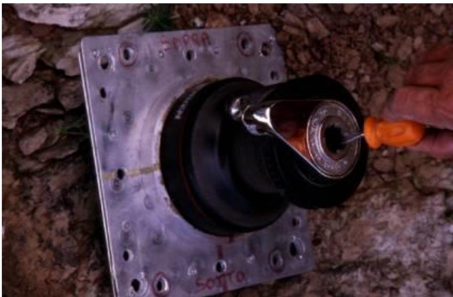
meccanismi interni di demoltiplica. Dopo di ciò si può girare la puleggia guida nella posizione che si preferisce. Per capire quale sia la posizione migliore per la puleggia guida occorre fare delle prove e regolarsi di conseguenza.
