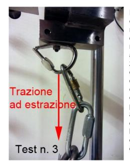
La trazione è stata ad estrazione, come riportato nella figura a sinistra, e quindi nelle condizioni migliori. Il cedimento è avvenuto sulla saldatura a 2526 kgp (immagine a destra) con una marcata deformazione del TOP 13 che ha assorbito 766 J. equivalenti all'energia prodotta da una massa di 80 kgp dopo una caduta di 1 m. Un risultato molto buono per uno strumento d'acciaio di piccole dimensioni.
