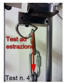
E' sempre un test ad estrazione ma l'appoggio è sulla chiusura a vite, simulando posizionamento un errato del nodo della corda, sempre possibile data la grande luce dell'ancoraggio. Nella figura sinistra la disposizione prima della trazione; nella figura a destra il risultato dopo la trazione a rottura, avvenuto con una forza di 1405 kgp. La deformazione è modesta e dissipa 365 J (80 kg di massa per una caduta di 0,50 m di caduta). Anche in questo caso siamo abbondantemente sopra il LIR.
