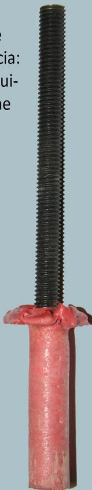
Per ogni tipo di resina sono stati effettuati 12 test a estrazione, 6 con foro asciutto e 6 con foro bagnato.
