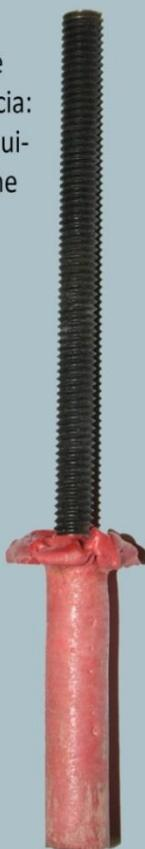
Con **HILTI RE 500** e **WURTH VIT PE 500** si è verificata la situazione "Secondo caso" di **Figura 4** con una adesione praticamente nulla fra resina e roccia e con riduzione della relativa forza  $F_{re}$  del 92,67 % e 95,06 % .
