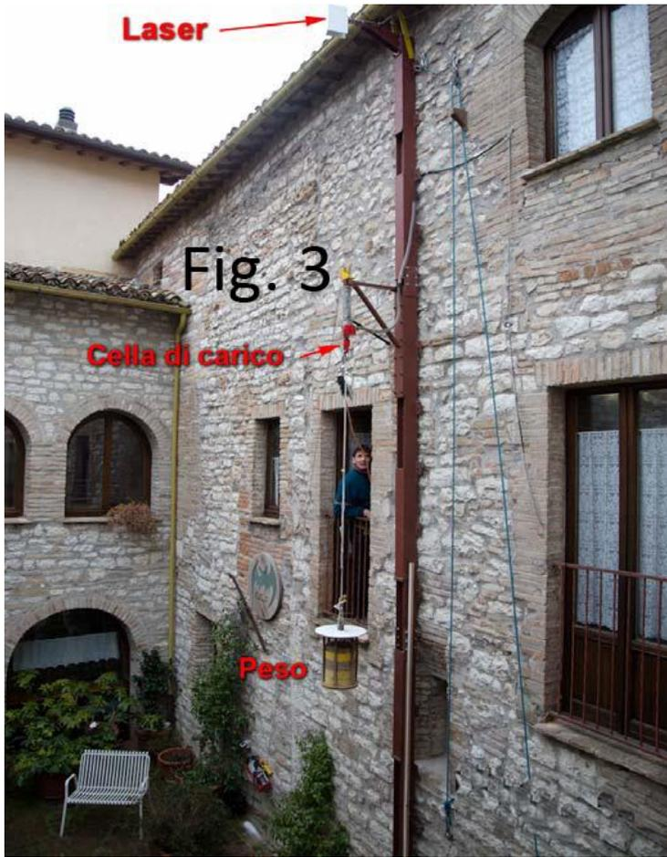
A questa trave sono applicati (con mensole) gli strumenti di misura della forza (**cella di carico dinamica**) e dell'allungamento (**sensore di spostamento laser**).
